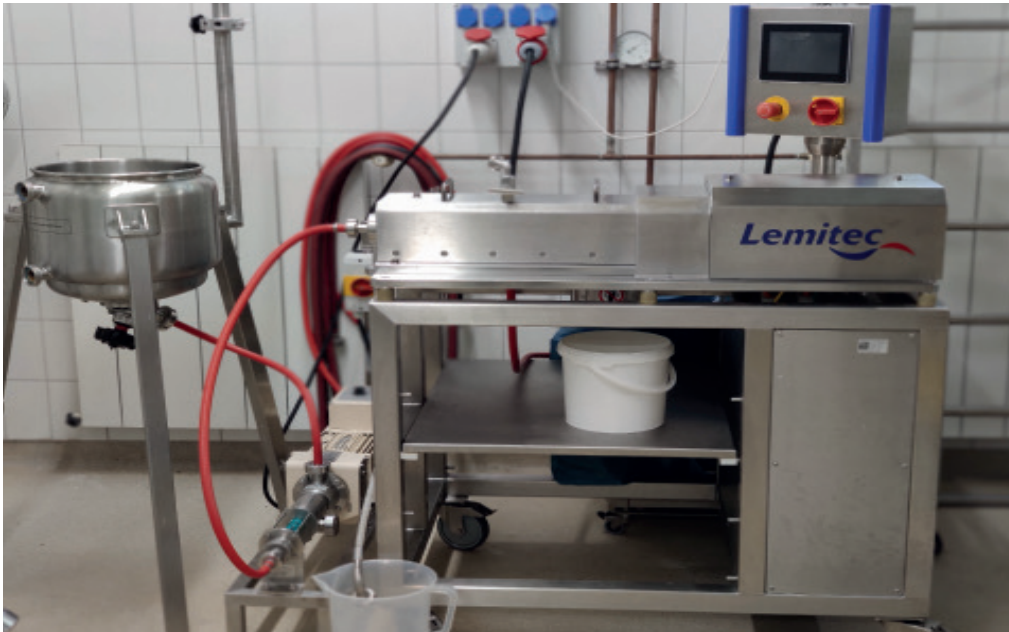
Abb.: Dekanter mit Vorlaufgefäß, Förderpumpe und Gefäßen für die „leichte Phase“ (flüssige Phase) und für die „schwere Phase“ (Feststoff), Quelle: Forschungs- und Lehrmolkerei
